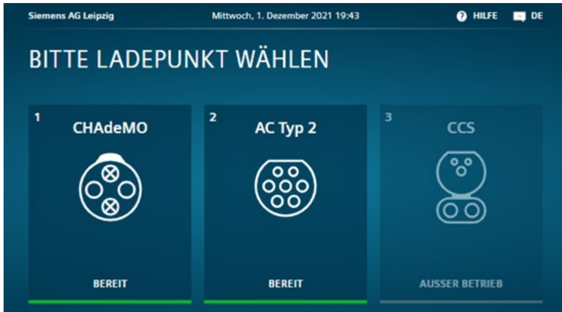
Bild 5-3 Fehlermeldung "Outlet außer Betrieb"
